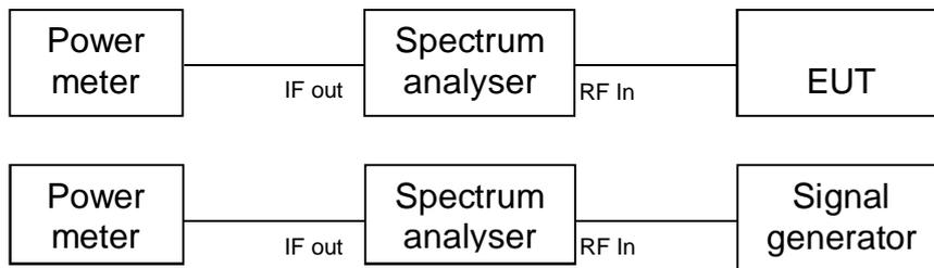
**5.5.4 Test set-up FHSS & DSSS**
