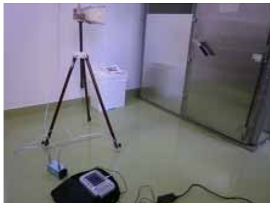
図 6 漏洩電界の測定風景
