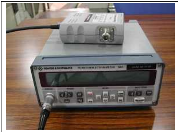
写真3.2.15. Power meter (NRT-Z43)
