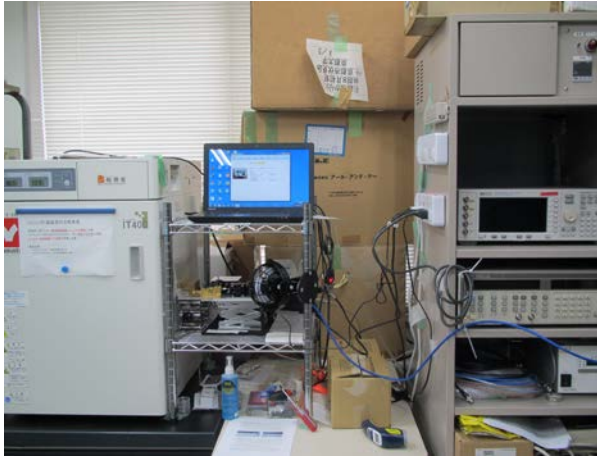
図 1-1 超高周波ばく露装置（右）と 超高周波ばく露用インキュベータ(左)
